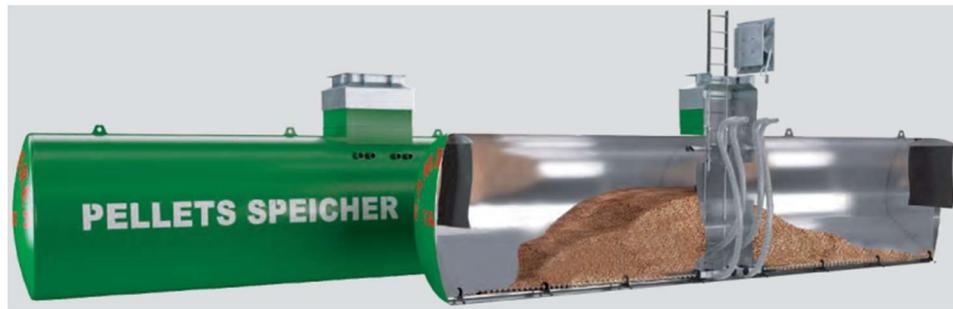
Die Pellet-Austragung transportiert die Holzpellets vollautomatisch mittels Saugsystem in die Tagesspeicher (2x 350kg) zu dem Heizkessel. Die Verbrennungsasche wird mittels einer flexiblen Schnecke automatisch in einen Behälter mit 240 Liter Fassungsvermögen befördert. Der Behälter (Volumen ähnlich einer mittleren Mülltonne) muss schätzungsweise 3x im Jahr geleert werden.
